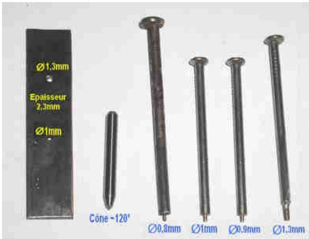
Le bout de fer plat de 2,3mm d'épaisseur (fer 2mm + laiton de 0,3mm) est percé à 1 et 1,3 mm. Les forets des différents  $\varnothing$  sont approvisionnables sur le site cité plus haut. Le poinçon conique est fait avec le reste d'un forêt au carbure cassé (ils sont très fragiles, mais très efficaces pour percer l'epoxy!). Pour le meuler conique, le mieux est un disque diamanté.
